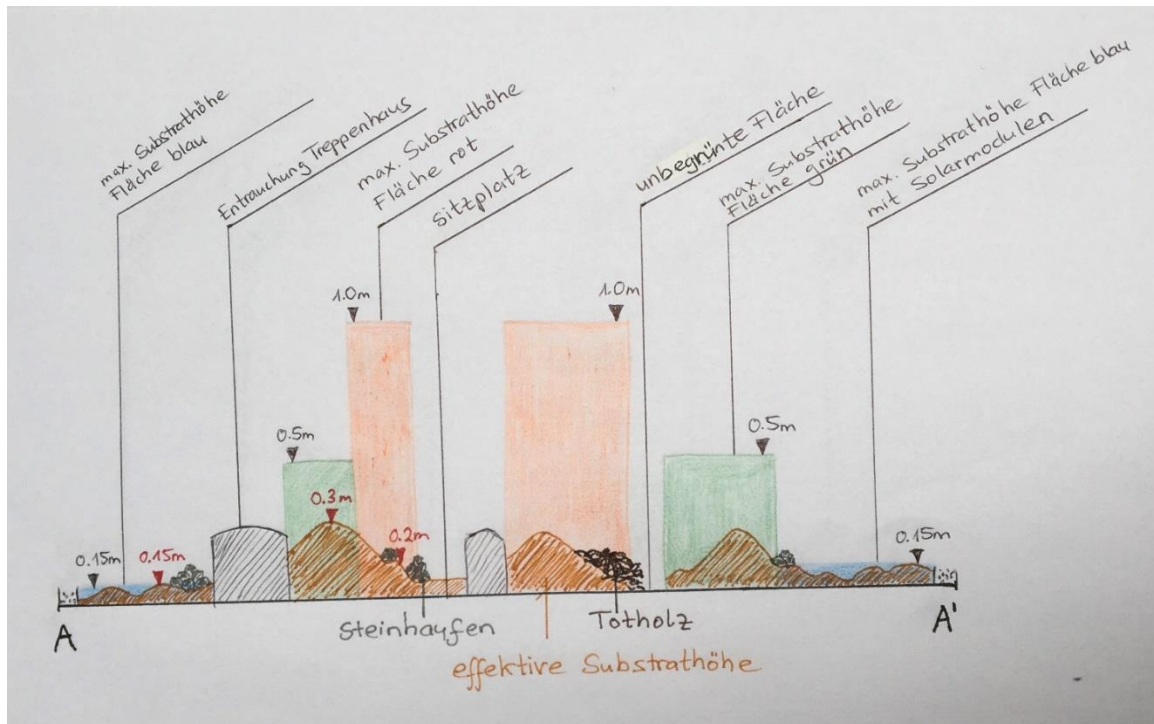
Abbildung 5: Schnitt AA' durch Substrataufbau mit maximalen und effektiven Substrathöhen sowie Strukturelementen (erstellt von N. Minder)
